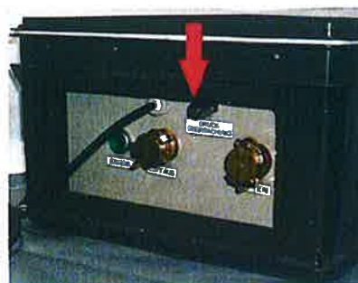
Anschluss Schlauch an Gebläse
